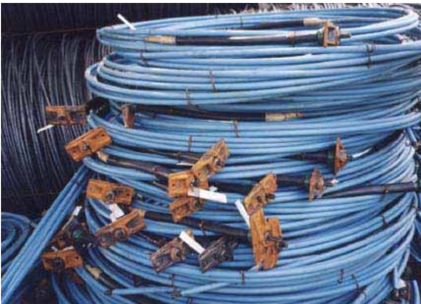
Cabos prontos para envio à obra, já com uma ancoragem firmemente fixada (pré-blocada) a uma das extremidades da cordoalha.
